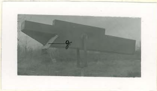
Fig. 4. "Dobson"- spektrografen. a jernrør, b jerngaffel, c sikteinretning, d viser, e zenittdistanseskala, f libelle, g platedekke.
