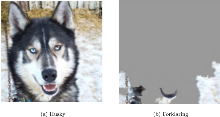
Figur 2.31: Forklarbar kunstig intelligens på husky og ulvehoder. (a) Viser et bilde av en husky som ukorrekt ble klassifisert som en ulv av en husky/ulv- klassifiseringsmodell. (b) Viser modellens beslutningsgrunnlag, og det som er farget med grått var ikke viktig for prediksjonen, i følge modellen. Resultatet er at det ser ut til at snøen i bakgrunnen var det viktigste for prediksjonen. Figurene er hentet fra Ribeiro et al. 2016 [117], Figure 11. Figuren er gjengitt med tillatelse fra Ribeiro et al. 2016.
