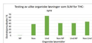
Figur 5: Ekstraksjonsutbytte av THC-syre ved bruk av ulike organiske løsemidler som SLM. NP: NPOE, Non: nonanol, Und: undecanol, Non-NP: nonanol/NPOE, Und-NP: undecanol/NPOE, Non-Und: Nonanol/undecanol. (Donor: 50 mM ammoniumacetat, akseptor: 70:30 v/v DMSO:50 mM ammoniumacetat)
