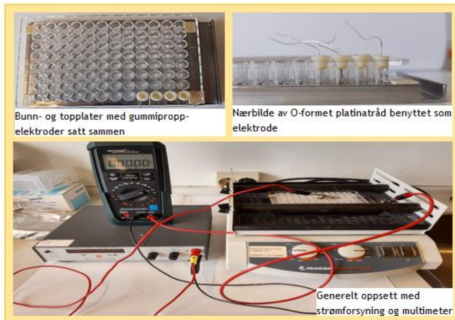
Figur 9 EME-oppsett med 96-brønnersformat hvor gummipropp-elektroder ble benyttet
