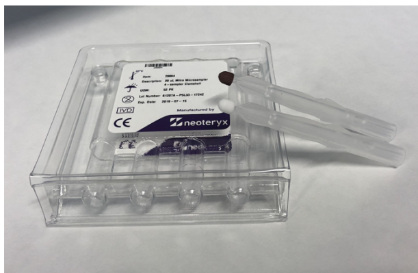
Figur 1: A) Volumetric Absorptive Microsampling (VAMS) med 20 µl Mitra Microsampler 4-sampler Clamshell. VAMS med hvit tipp er ubrukt. VAMS med rød tipp er brukt VAMS som inneholder fullblod etter prøvetaking. B) Tre rader med VAMS-tipper i 96-brønnplaten som er klare for PALME-ekstraksjon.
