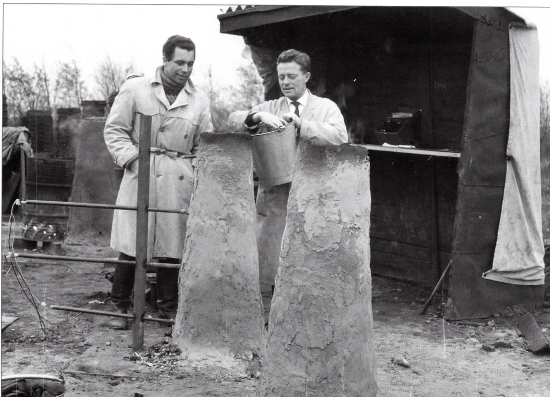
Figur 6: Olfert Voss og Robert Thomsen (til højre) ved forsøg med jernudvinding på A/S Varde Staalværk 1963. Foto: Varde Lokalhistoriske Arkiv.
