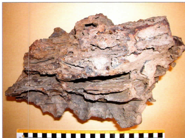
Figur 11: En del av ett av de stora slaggblocken från en av ugnarna i Valbo socken, Gästrikland, med tydliga horisontella parallella vedavtryck. Foto: GAL.
