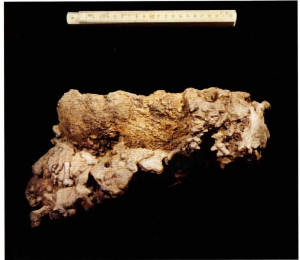
Figur 4: Slagge fra Espevej. Slaggen har hængt i overgangen mellem ovnskakten og slaggedrænet.
