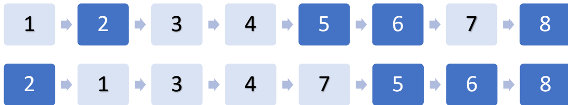
Figur 2.2: Figuren viser to versjoner av en tenkt prosess som opprinnelig gjennomføres i stegene 1-8. Dersom prosessen deles opp åtte adskilte arbeidsoppgaver, ser vi at oppgave 1, 3, 4 og 7 egner seg for automatisering, mens oppgave 2, 5, 6 og 8 krever menneskelig vurderingsevne og kan derfor ikke automatiseres ved RPA. For å effektivisere prosessen ønsker man derfor å samle oppgave 1, 3, 4 og 7 slik at roboten kan jobbe sammenhengende, noe som gir økt effektivitet (Lacity & Willcocks, 2017).
