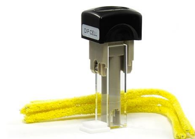
Figur 13: «dipp-cell»-type elektrode, brukt for å måle zetapotensial ved hjelp av Zetasizer nano series (Nano – ZS), Malvern Instruments UK. Bildet er hentet fra
