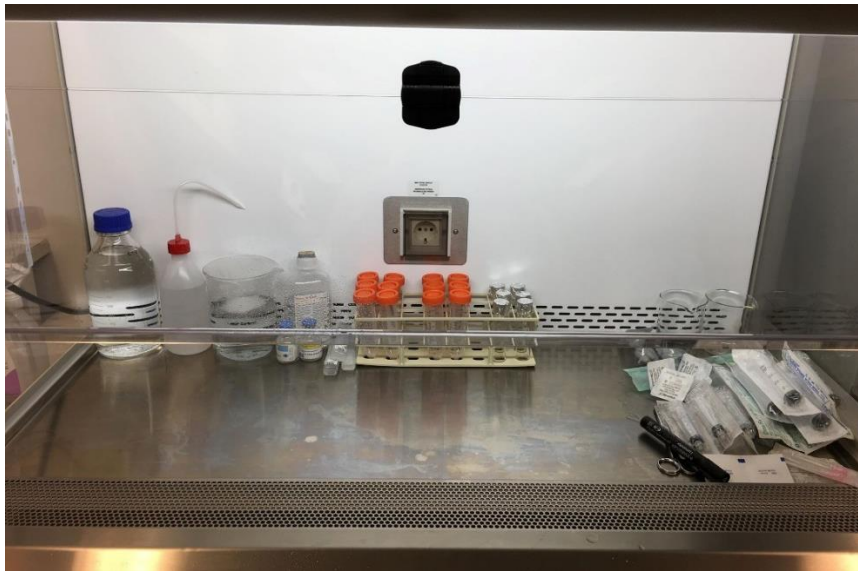
Figur 9: Utstyr og arbeidssone klargjort for prøveopparbeidelse i LAF-benk med vertikal luftstrøm
