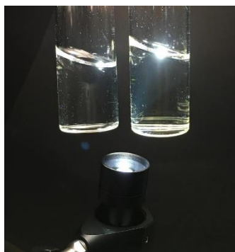
Figur 15: Tyndall-metode med fokusert fiberlysstråle på prøver (kontroll av vankomycin og vankomycin + TPNaq)
