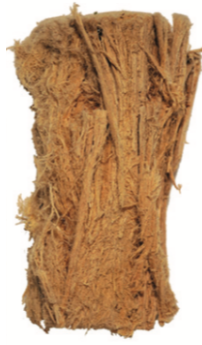
Figur 14. Treverk som er nedbrutt av salt. Fra Forest Products Laboratory 2011:2.
