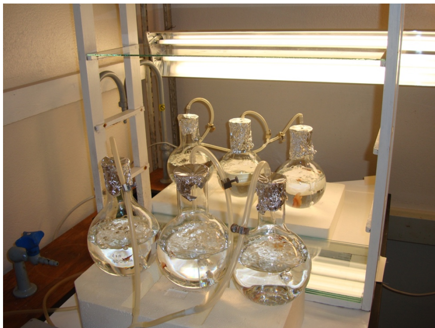
Figur 12: Figuren illustrerer eksperiment i boblekultur. De tre bakerste rundkolbene har lysintensitet 10 \mu\text{mol m}^{-2} \text{s}^{-1} og de tre fremste kolbene har lysintensitet 5 \mu\text{mol m}^{-2} \text{s}^{-1}
