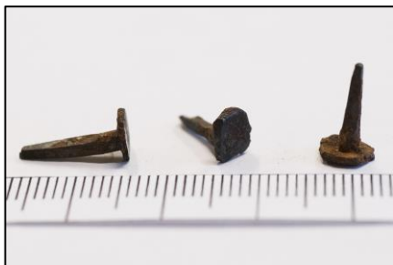
Fig._ Spikertype 1: Håndsmidd og filt
