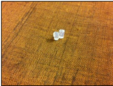
III.22 pH overflate-indikasjonsmåling med kuber av agarosegel fpå lerretsbacksiden
