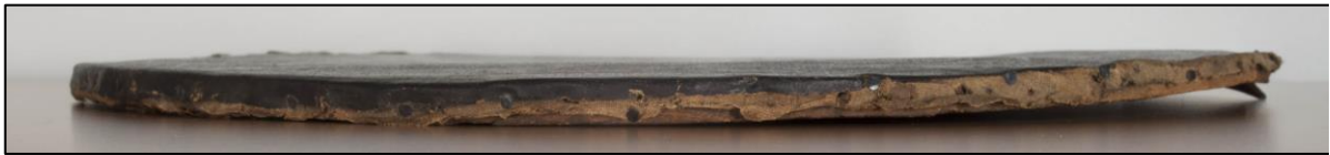
D. Oppspenningskanter langs øvre side og vridning i listen
