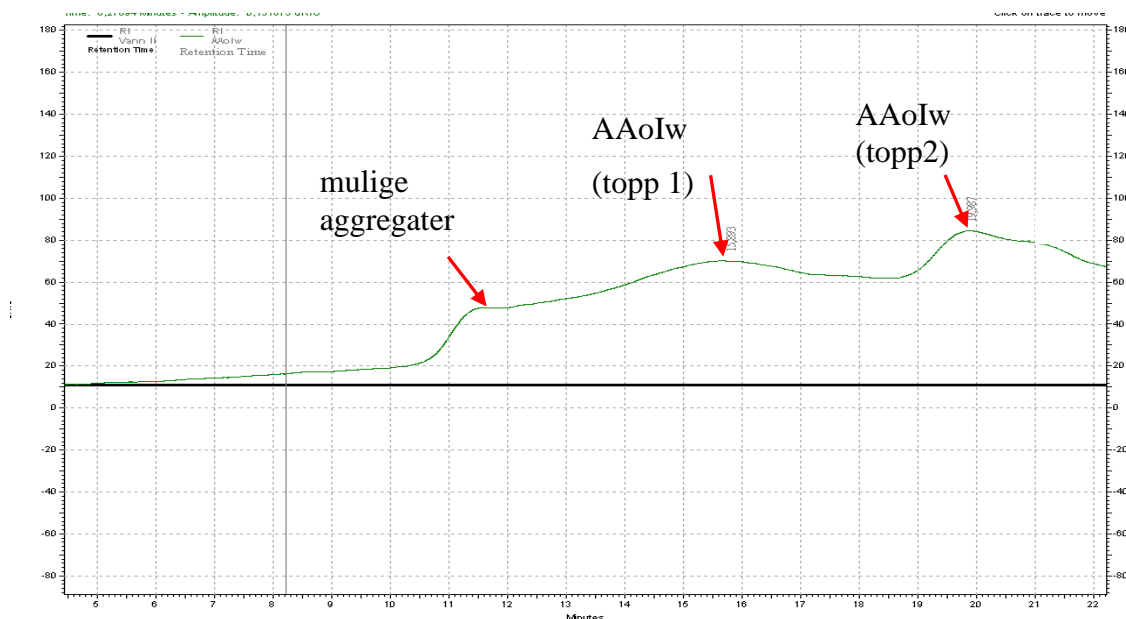
Figur 37. Kromatogram fra SEC-HPLC analyse av AAoI w . TSK-Gel® G5000PW XL .
