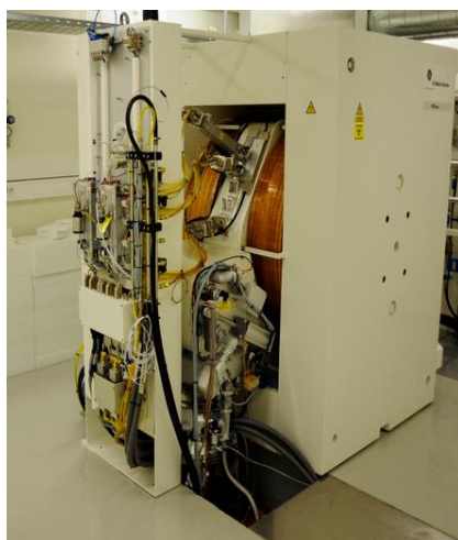
Bilde 2: Syklotron, en maskin som brukes for produksjon av radioaktive isotoper
