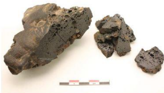
Figur 6. Det delade slaggstycket i prov 518 som analyserades. Ett större slaggflöde kan urskiljas. Det högra stycket preparerades till tunnslip medan bitarna i mitten analyserades totalkemiskt.
