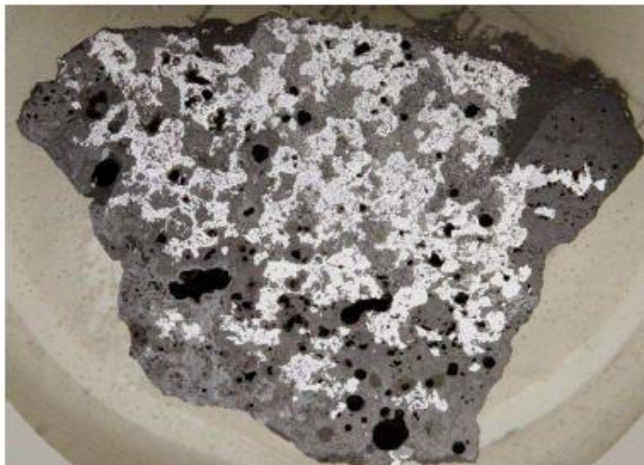
Figur 11. Det färdigpreparerade järnprovet 518, ingjutet i plast och polerat. Tvärsnittets storlek är ca 31x24 mm.
