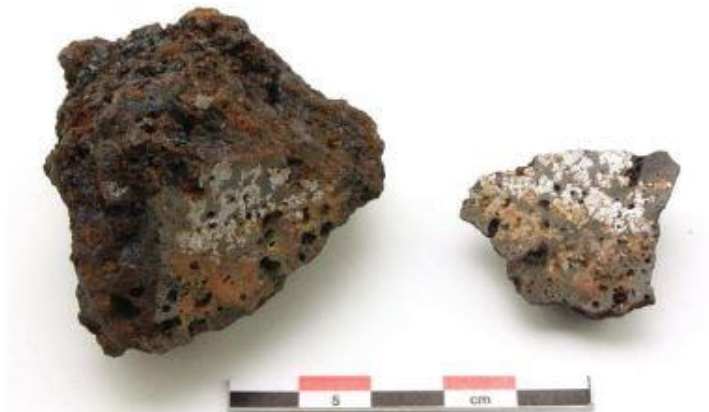
Figur 10. Järnstycke 518 i tvärsnitt. De ljusa/rostbruna partierna är metalliskt järn och de mörka/grå består av slagg.
