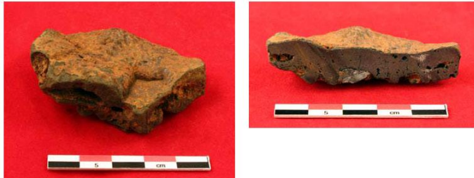
Figur 1. Slaggen C57518/2 en tappslagget med tydligt kyld, skrynklig, ovansida i övre bilden. Undre bilden visar den homogena slaggen i delat tvärsnitt med insmält fragment i botten.
