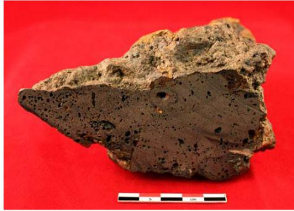
Figur 8. Slaggen C57518/17 del av en bottenlagg med homogen sammansättning.
