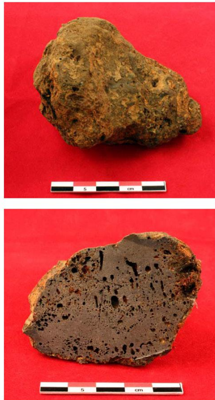
Figur 4. Slaggen C57518/3 del av en bottenlagg. Tvärsnittet i nedre bilden visar en slag med homogen sammansättning men skiktad med avseende på porförekomst.
