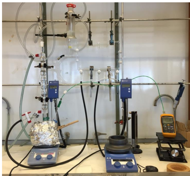
Figur 36: Synteseoppsett for polyolmetoden. Rundkolben er tildekket med kvartsull og aluminiumsfolie. Til rundkolbene r det festet et inntak for argongass, en kjølefelle og temperaturen i løsningen blir logget med en temperaturlogger. Hele oppsettet er plassert i avtrekk.
