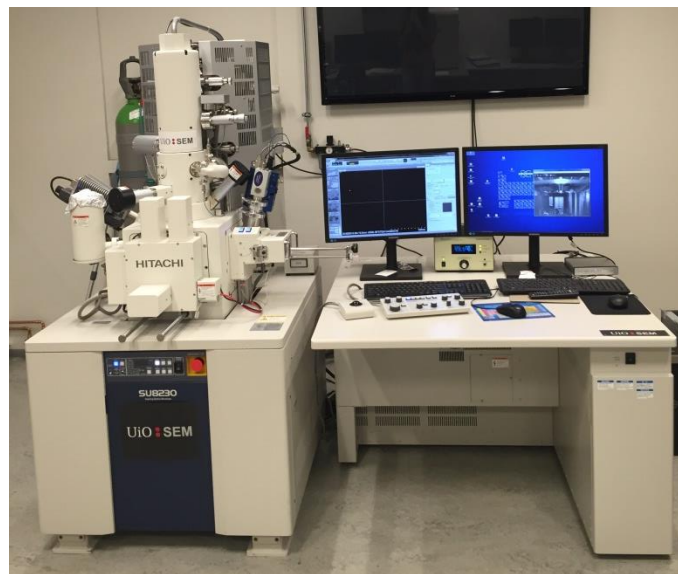
Figur 37: Bilde av SEM-en som har blitt brukt i arbeidet, en HITACHI SU8230 Ultra High Resolution Cold FE-SEM.
