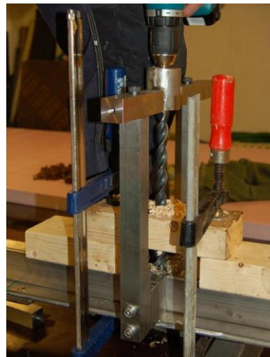
figur 17. Montering av borejig og prøveboring. Foto Pål Thome, NMM.
