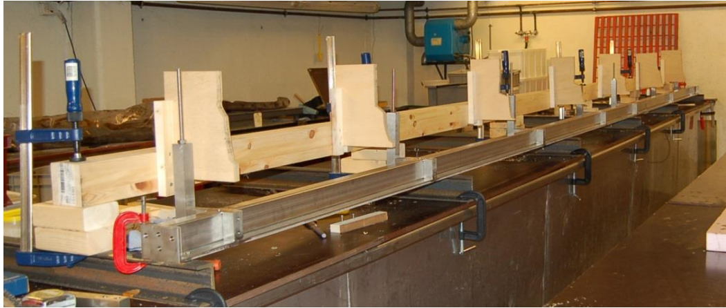
figur 16. Stålbejelke med støttejern og snitt montert. Foto Inger Marie Egenberg, NMM.
