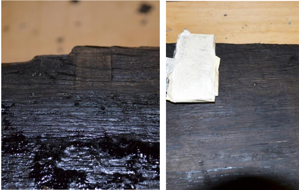
figur 23. Eksempler på trykkskader. Av kryssfiner til venstre og kile uten filt til høyre. Foto NMM
