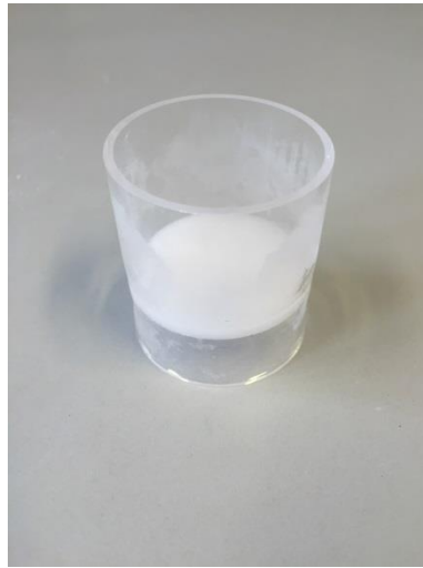
Figur 3-3: På grunn av kontaminering fra jernpartikler ble denne kvartsylindere med et kvartfilter brukt. Sylindere har en radius på 40mm og en høyde på 5 cm.
