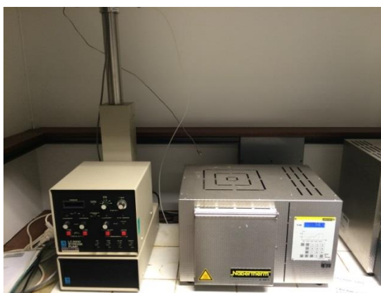
Figur 3-2: Til venstre ses HPLC pumpen brukt under den hydrotermiske behandlingen og til høyre ses multistep ovnen. Vannet tilføres fra pumpen til dampkjelen igjennom jernrøret som ses bak HPLC pumpen. Røret kobles til kjelen igjennom et hull bak i ovnen.
