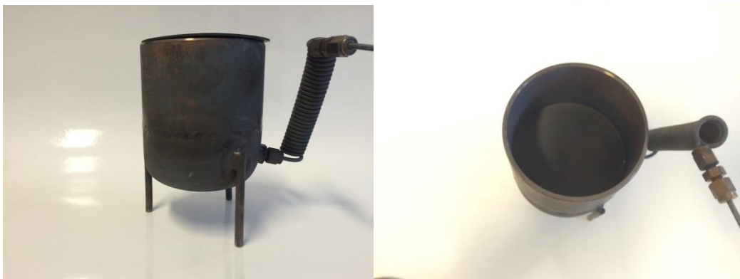
Figur 3-1: Dampapparatet brukt for hydrotermisk behandling av prøvene. Prøven legges på den porøse membranen vist i bunn av apparatet på bildet til høyre. Apparatet lukkes med et porselenlokk. Først ble det brukt et jernlokk, men dette viste seg å dekomponere og flasse av jernpartikler. Vannet kobles til på spolen på siden av apparatet og føres inn i et lukket rom under den porøse membranen.
