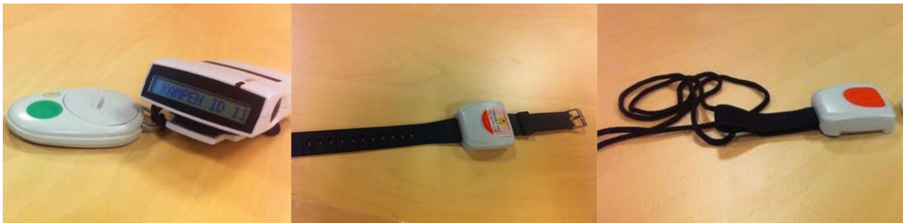
Figur 1: Fra venstre: Personsøker og avstiller, trygghetsalarm på armbånd, trygghetsalarm på snor
