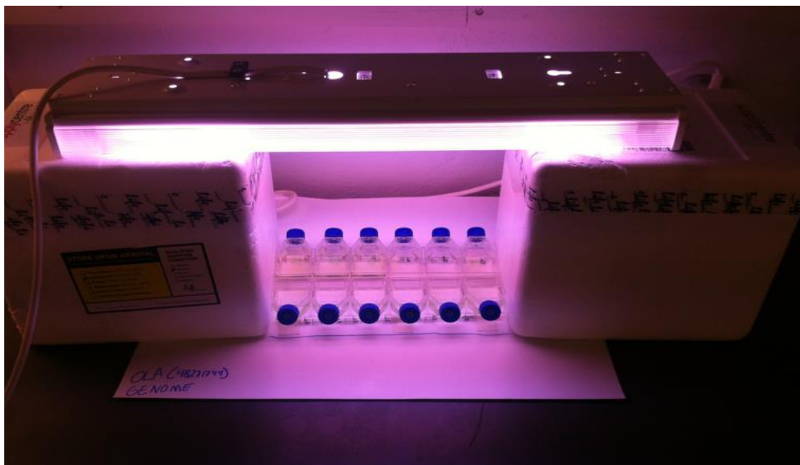
Figur 1: Belysningsoppsett for algene i hvert av klimarommene.
