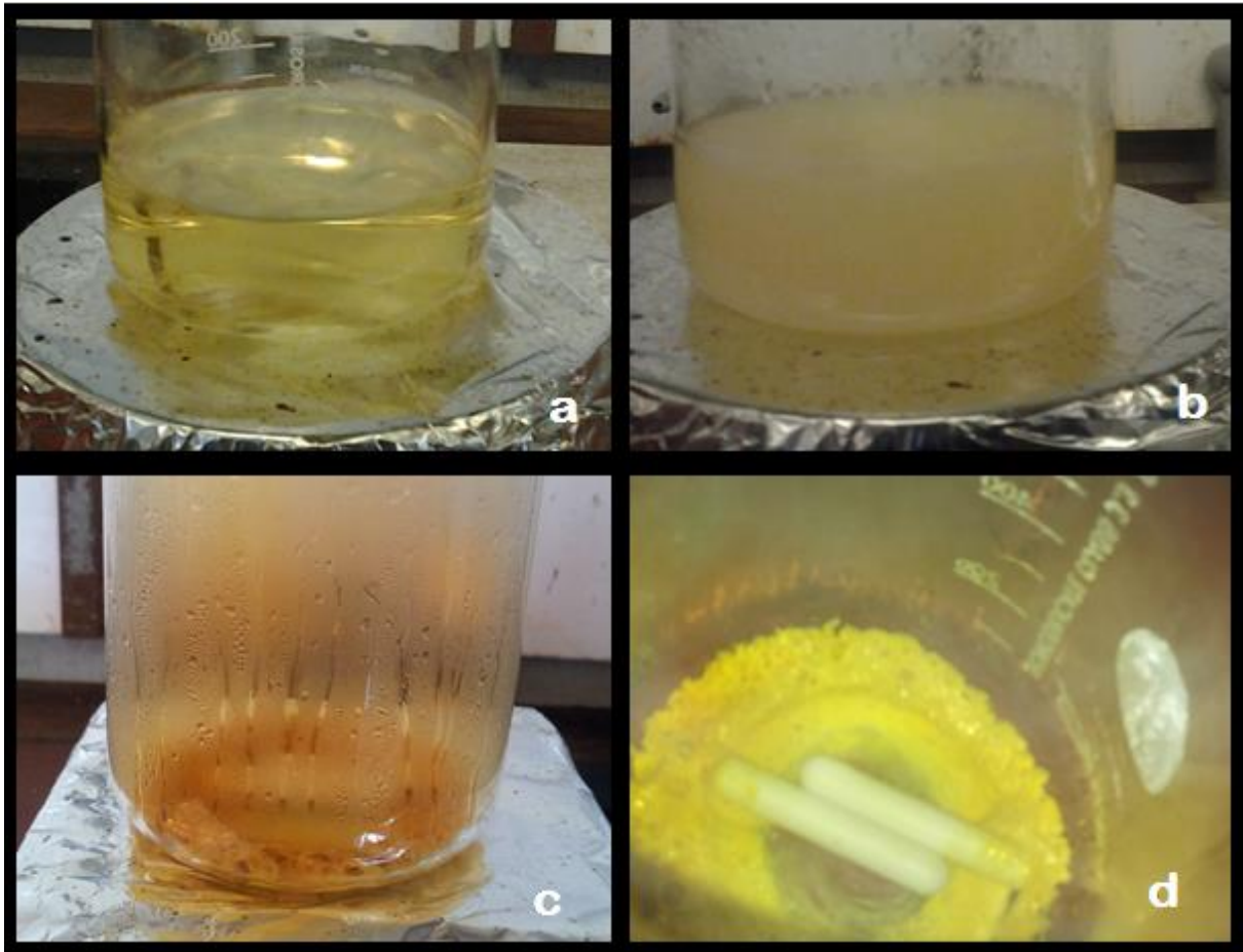
Figur 4.3 , viser syntesegangen for \text{LiFePO}_4 . Bilde (a) er løsningen etter å ha blitt blandet med vann. Bilde (b) viser utfelling i løsningen. Bilde (c) viser fargeendring og avbrenning av nitrøse gasser. Bilde (d) viser løsningen før den settes inn i ovnen.
