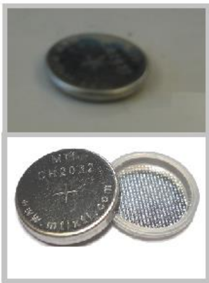
Figur 4.7, viser et knappcellebatteri. Øverst er det et batteri laget for denne oppgaven, nederst er et illustrasjonsbilde fra produsentens hjemmesider [51].
