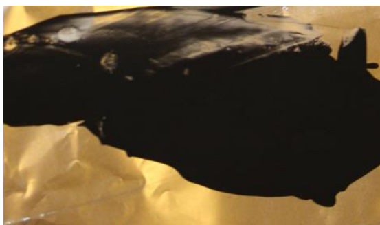
Figur 4.6, viser katodetape tørket på aluminiumsfolie
