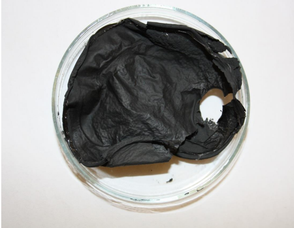
Figur 4.5 En katodetape tørket på glassplate.
