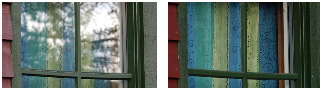
Figur 10.6: Upolarisert lys som reflekteres i en luft-glass-grenseflate kan bli fullstendig polarisert når innfallsvinkel er lik Brewstervinkelen. Disse fotografiene viser dette. Venstre bilde er tatt uten polarisasjonsfilter. Høyre bildet er tatt med et polarisasjonsfilter dreid slik at det bare slipper gjennom lys med polarisering parallelt med innfallsplanet. All refleksjon ved Brewstervinkelen fjernes da, og vi ser direkte inn mot gardinene på innsiden av glassruten praktisk talt uten noe reflekser. Det betyr at alt reflektert lys ved Brewstervinkelen er fullstendig polarisert i en retning vinkelrett på innfallsplanet (parallelt med grenseflaten luft - glass). Merk forøvrig at reflekser på malingoverflaten påvirkes på lignende måte som reflekser fra glasset.
