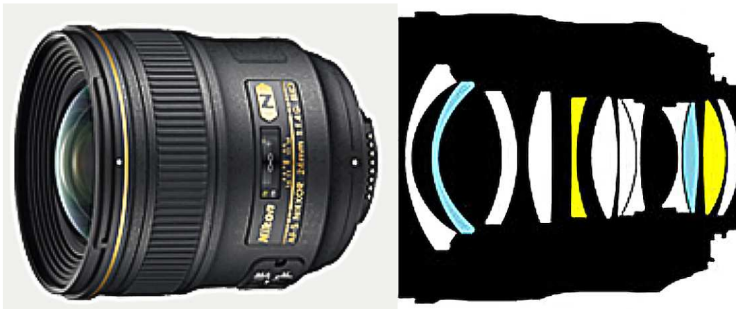
Figur 12.6: Eksempel på et moderne objektiv for fotografi: AF Nikkor 28 mm f/1.4 GED objektiv. I stedet for én enkel tynn linse, slik vi tenker oss et objektiv i vår gjennomgang av geometrisk optikk, har Nikon-objektivet 12 linser som spiller sammen som én. De fleste enkeltlinsene har sfæriske overflater, men to (de blå) har ikke-sfæriske overflater. To linser (de gule) er laget av ekstra dispersivt glass, det vil si at brytningsindeksen har en annerledes variasjon med bølgelengden enn det som er mest vanlig i andre glasstyper. Illustrasjonene er hentet fra websidene til Nikon 6. april 2013.
