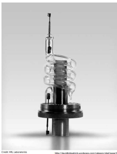
Figur 14.14: Foto av den første laseren. Et blitz-rør omkranser en rubinstav. Rubinstaven er belagt med et nær 100 % reflekterende speil i ene enden og ca 95 % reflekterende speil i andre enden. Laseren ga fra seg pulset koherent lys. Fotografiet ble frigitt fra Hughes Research Laboratories i forbindelse med 50-årsjubileet i 2010.
