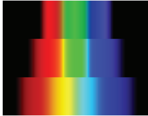
Figur 11.13: Spekter fra en smal spalt (øverst) og fra økende spaltbredde nedenfor.
