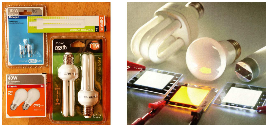
Figur 11.4: Eksempler på dagens lyspærer (til venstre). Effekt, lysstrøm, levetid i timer og spenning er angitt: 10 W halogenpærer (130 lumen, 3000 t, 12 V), 40 W Classic (300 lumen, 2500 t, 240 V), 11 W sparepære (“= 60 W”) (650 lumen, 10000 t, 240 V), og 9 W lysstoffrør (“= 60W”) (600 lumen, ukjent levetid, 240 V anlegg). Til høyre: Bilde av organisk lys-emitterende dioder (oled-panel) sammen med noen vanligere lyskilder. Bildet er hentet fra en artikkel om oled skrevet av Gary Boas i Photonics spectra februar 2010.
