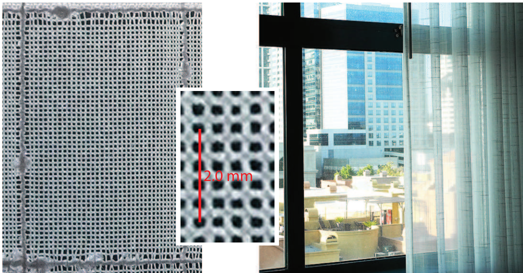
Figur 13.26: Bildet fra et lett gardin som det var mulig å se gjennom. Detaljer viser hvordan fibrene i gardinet lå i forhold til hverandre. Staven i midtre del er opprinnelig 2.0 mm lang.
