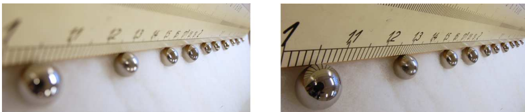
Figur 12.24: Når et lysende punkt i et objekt avbildes av en linse, vil det avbildes omtrent som et punkt i det aktuelle fokalplanet. Dersom vi skal avbilde flere objekter som ikke har samme avstand til linsen, finnes det ikke ett fokalplan for bildene som dannes. Da vil lysende punkter i objekter som har en annen avstand til linsen enn det vi har fokusert på, bli avbildet som sirkulære skiver, og bildet blir “uskarpt”. Ved å redusere åpningen til blanderen vil uskarpheten bli redusert (vinkel \phi_2 er mindre enn vinkel \phi_1 i figur 12.23), og vi sier at vi har fått større dybdeskarphet. I venstre fotografi er det brukt et objektiv med blendertall 3.5 og lukkertid 1/20 s, i høyre foto er det brukt samme objektiv og fokusering, men nå med blendertall 22 og lukkertid 1.6 s.
