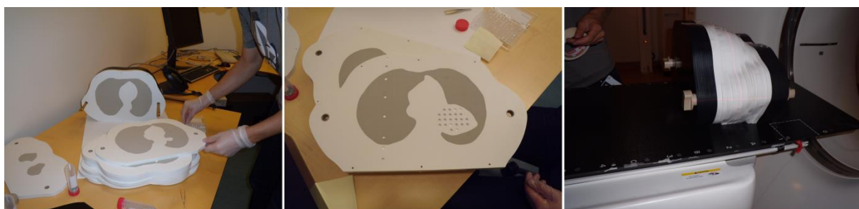
Figur 3.3: Figuren viser oppbygning av lungefantomet. Bildet til venstre og i midten viser sammensetningen av de ulike snittene i fantomet. Bildet til høyre viser det sammensatte fantomet.
