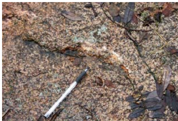
Figur 3_7: Bustgård (lokalitet 34). Typisk sterk overflateforvitring med lokalt 1–2 cm tjukk forvittringshud i langtidseksponert Iddefjordgranitt. Forvitringa er sterkast nær buskar og anna vegetasjon, der det blir danna humussyrer frå nedbryting av planterestar. På opne flater utan særleg innslag av lav var forvittringsomfanget tydeleg mindre. Foto: Per Hagelia.
