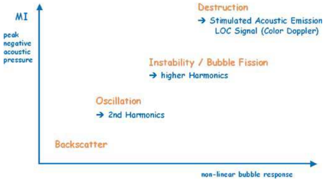
Figur 3 Responsen til mikroboblene er hovedsakelig avhengig av amplituden til de akustiske trykkbølgene, som kan uttrykkes som MI. Høyere krefter kan føre til at mikroboblene deles i 2 (fisjon) eller forsvinne helt (ødeleggelse). [10]
