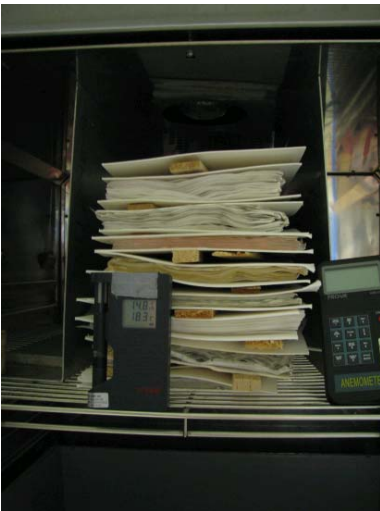
Bilde 7. Papirbunker i tørkekammeret under tørking, forsøk 3.1. Til høyre i bildet sees anamometeret.
