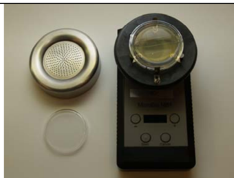
Bilde 11. Microbio for å ta luftanalyser med hensyn på spiredyktige muggsoppsporer. Foto: Mycoteam.
