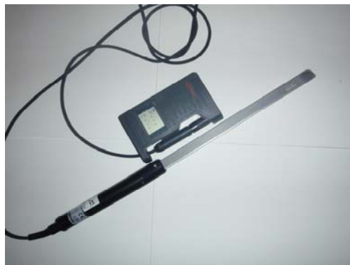
Bilde 6. Hygrologg Rotronic med 'papirsverd': flat sensor som kan stikkes inn i papirbunken og måle RF der.
