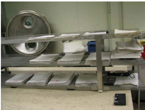
Bilde 3. Frosne papirbunker lagt utover på stativet som skal inni frysetørkeren. Start forsøk 2.1.
