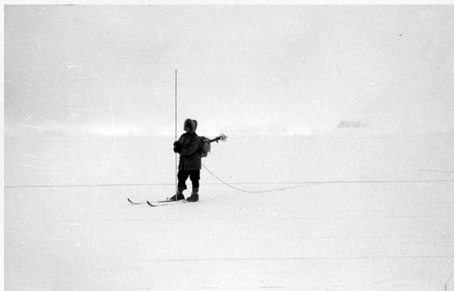
Sondering i Hellstugubreens firnområde. Sonden støtes ned til sommeroverflaten og snölagets tykkelse måles. Avstanden mellom sonderingspunktene måles med tau. Til arbeidet bør det være 2 personer.
