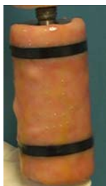
Figur 10: Metallsylider med tarmen på
