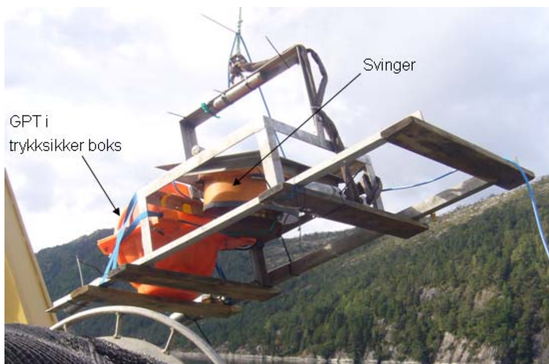
Figur 2.2 Akustikk oppsett. Svingeren er montert i en stålramme med koblinger som forsikrer horisontal posisjon. GPT er montert i en glasskule og i en beskyttende oransje plastbeholder.
