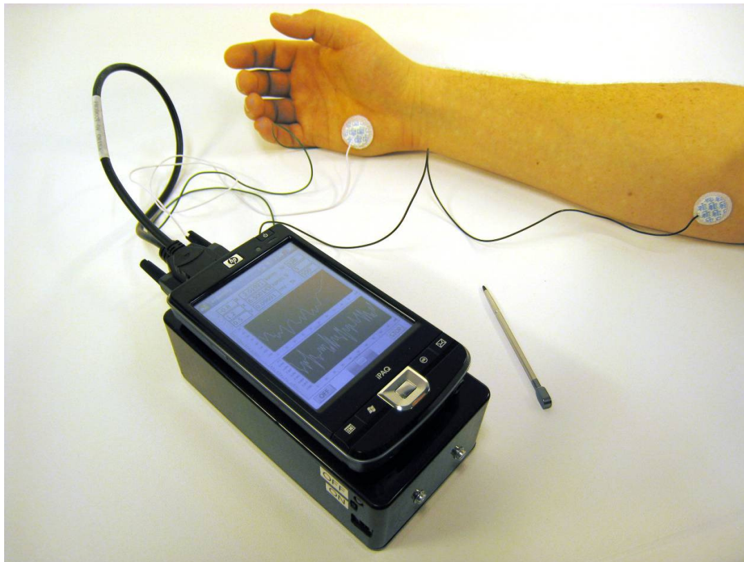
Figur 5.10: Måleinstrumentet koblet til en forsøksperson. En av de tre elektrodene er festet på hånden på dorsal side, og vises ikke på bildet (se figur 4.17)
