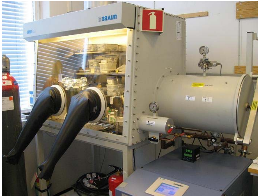
Figur 2.3.1: Hanskeboksen på IFE benyttet ved prøvepreparering og til lagring av prøver. Slusesystemet kan sees til høyre.
