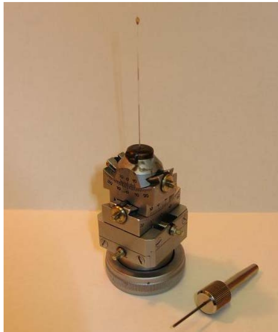
Figur 2.4.9: Goniometerhodet til IFE med et kapillarrør montert. Nøkkelen til høyre brukes til å justere kapillaret så det peker rett.
