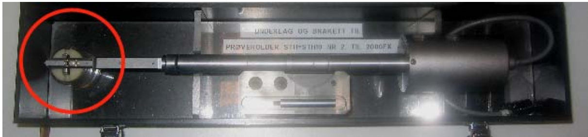
Figur 2.5.10: Prøveholder ved TEM-undersøkelser. Festet for kobbernettet er vist med en rød sirkel.
