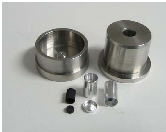
Figur 2.6.6: Prøveholderne i aluminium som ble benyttet ved DSC-målinger (nederst til høyre). Øverst i bildet er verktøyet til å presse lokket sammen, mens en grafittinnsats er vist nederst til venstre.
