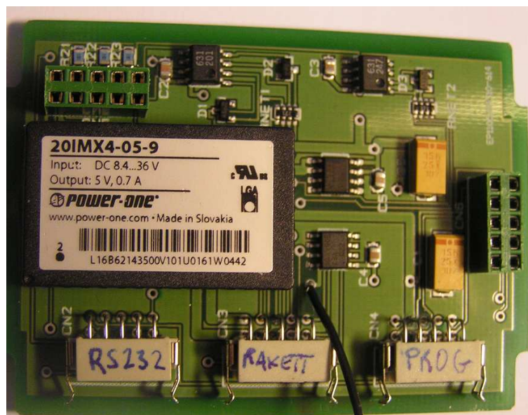
Figur 4.6: Bilde av strømforsynings- og grensesnitt kortet.
